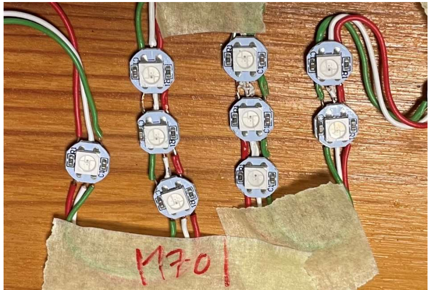
Abbildung 23: Nah zusammengelötete LEDs für den Axonhügel
