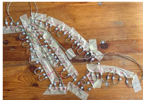
Abbildung 22: Ausschnitt der vorbereiteten LED-Kette. Schlaufensystem sichtbar
