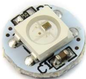
Abbildung 20: Abbildung einer Ws2812b LED mit dem darunterliegenden Neopixel
